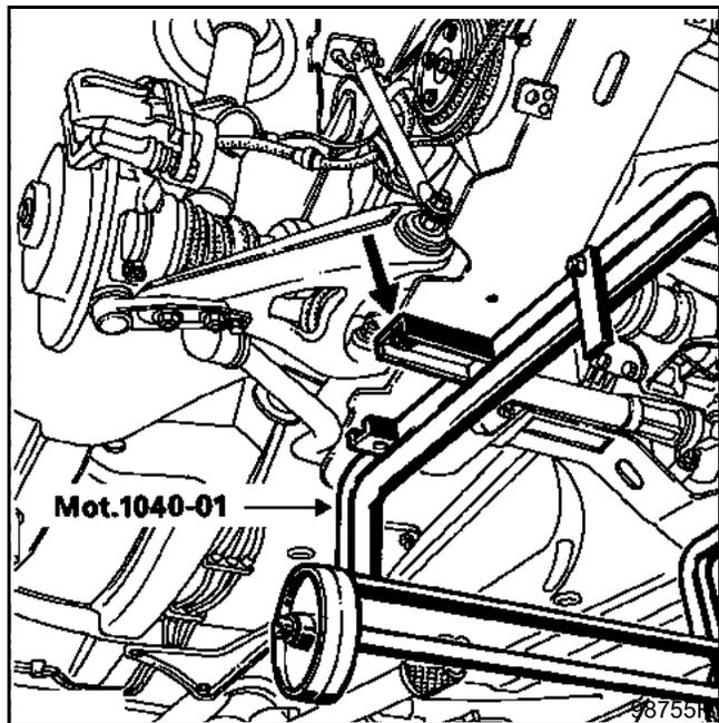
Опустите подъемник до касания приспособления с грунтом.
