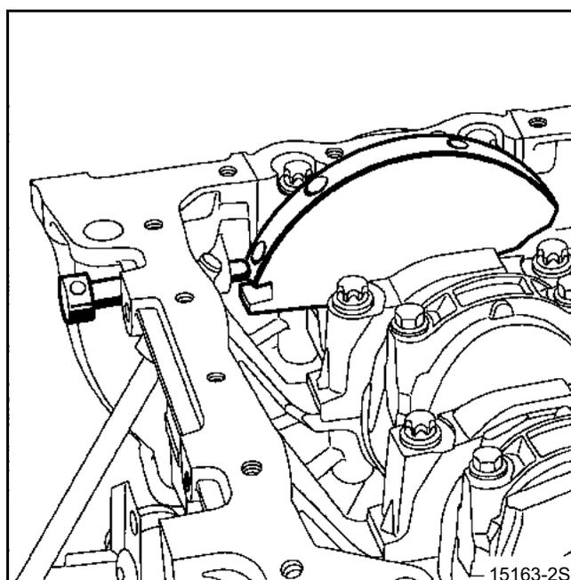
Проверните немного коленчатый вал в том же направлении так, чтобы фиксатор **Mot. 1054** оказался в блокировочном отверстии коленчатого вала.
