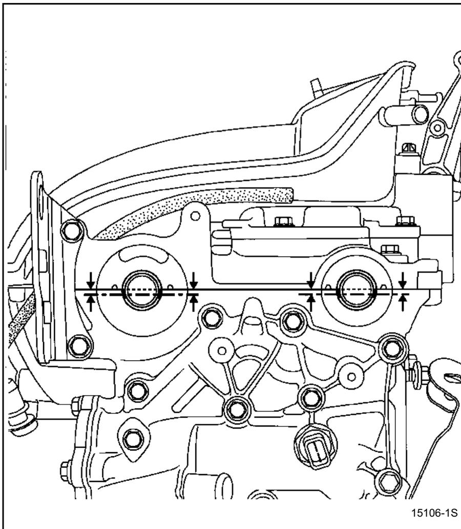
Зафиксируйте приспособление **Mot. 1496** на концах распределительных валов.
