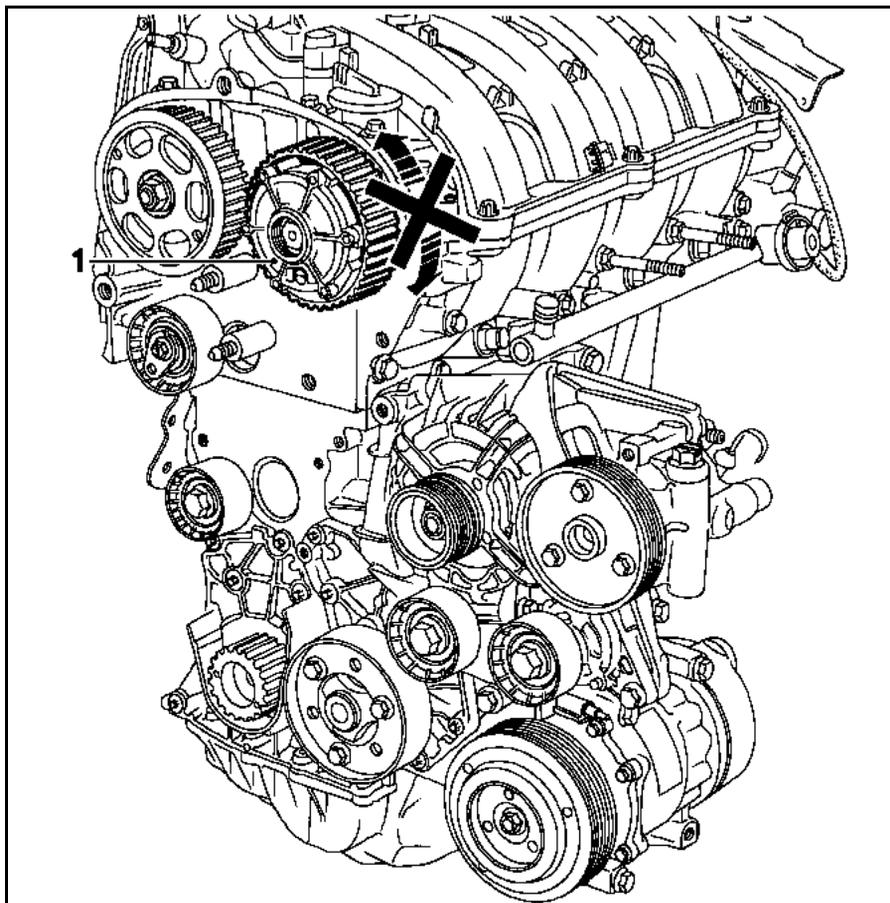
В состоянии покоя электромагнитный клапан закрыт. Он разрешает подвод масла для управления фазорегулятором в зависимости от работы двигателя:
