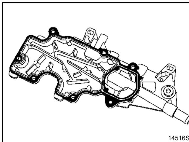
Установите маслоотстойник и затяните болты его крепления моментом **1,3 даН.м** в требуемом порядке.
