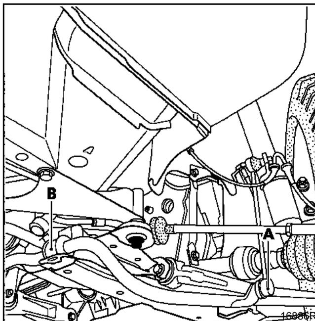
Выверните болт клеммного соединения вилки карданного шарнира рулевого вала.
