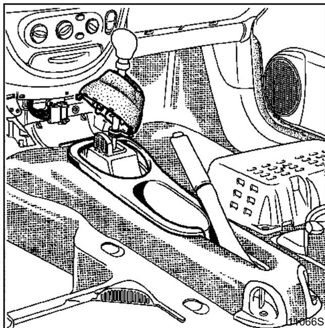
Выверните четыре болта крепления скобы (два спереди, два сзади).
