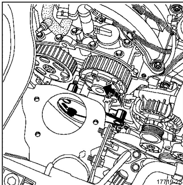
Поверните приспособление **Mot. 1509** пока детали не встанут в положение, которое указано на рисунке ниже.
