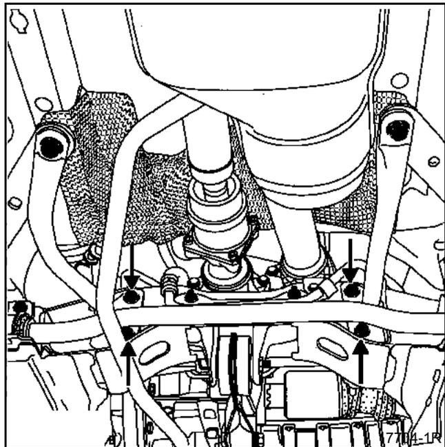
Закрепите в подвешенном состоянии рулевой механизм и радиатор системы охлаждения вместе с конденсором.
