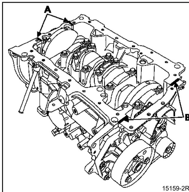
Установите масляный поддон с новой прокладкой, предварительно выполнив усадку прокладки, затянув болты крепления поддона моментом **0,8 даН.м** после чего окончательно затяните болты моментом **1,4 даН.м** в указанном на рисунке порядке.
