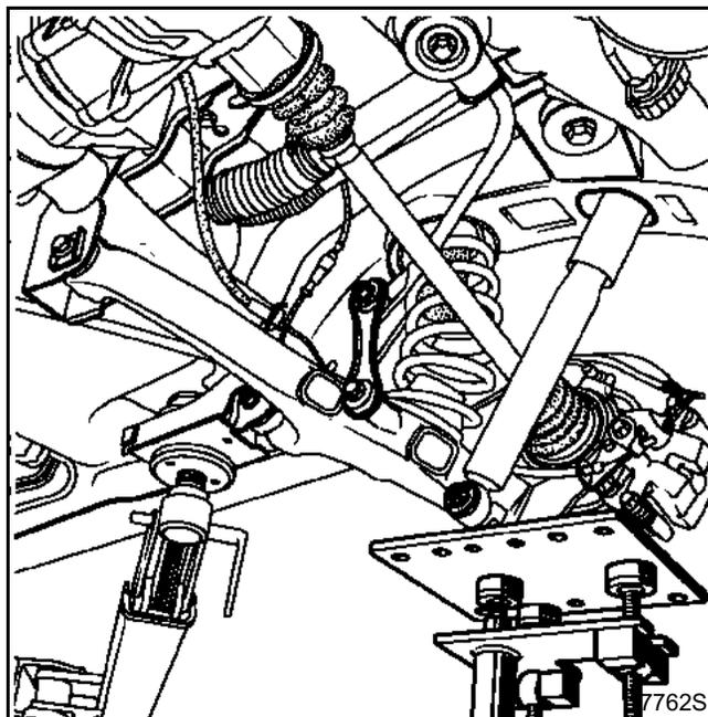
Медленно опускайте гидравлический домкрат, извлекая при этом хвостовик приводного вала из ступицы.
