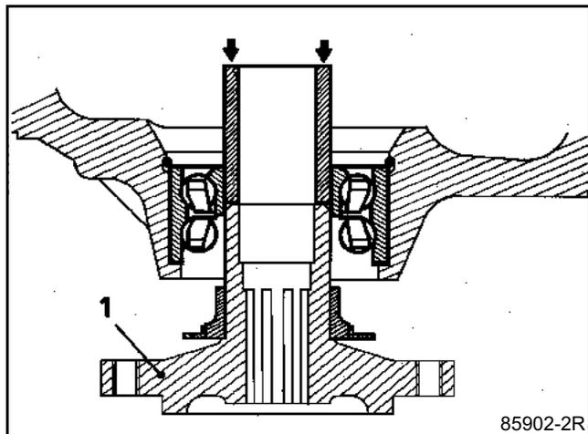
Снимите внутреннее кольцо подшипника, используя приспособления из набора съемников подшипников ступицы (2).
