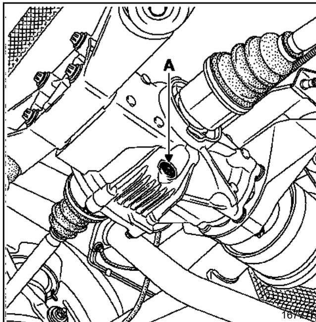
Заправка масла и проверка уровня производится через отверстие, закрываемое пробкой (B).
