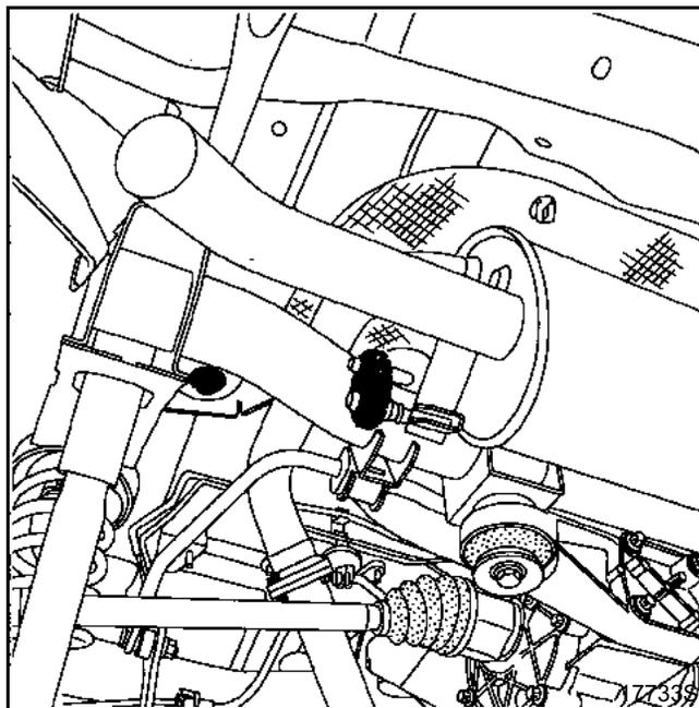
Выверните четыре болта (А) крепления подрамника.
