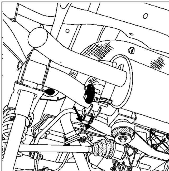
– трубопроводы задних тормозных механизмов.
