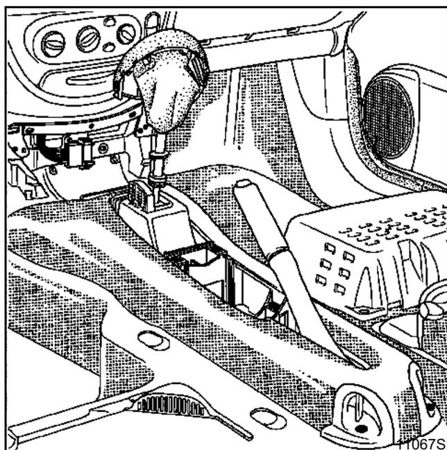
Приподнимите скобу, чтобы высвободить рычаг привода стояночного тормоза.
