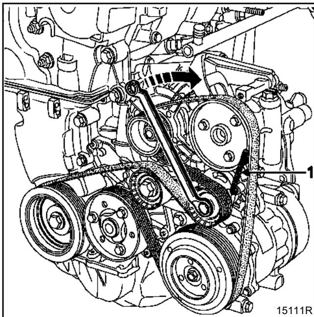
**РЕМЕНЬ ПРИВОДА ГЕНЕРАТОРА, НАСОСА ГИДРОУСИЛИТЕЛЯ РУЛЕВОГО УПРАВЛЕНИЯ И КОМПРЕССОРА**
