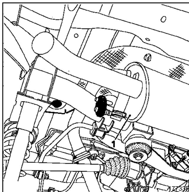
Отметьте положение фланцев карданного вала относительно кузова.
