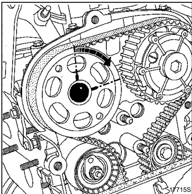
Снимите приспособление **Mot. 1496** для фиксации распределительных валов, приспособление **Mot. 1509** для фиксации зубчатых шкивов распределительных валов и фиксатор верхней мертвой точки **Mot. 1054**.
