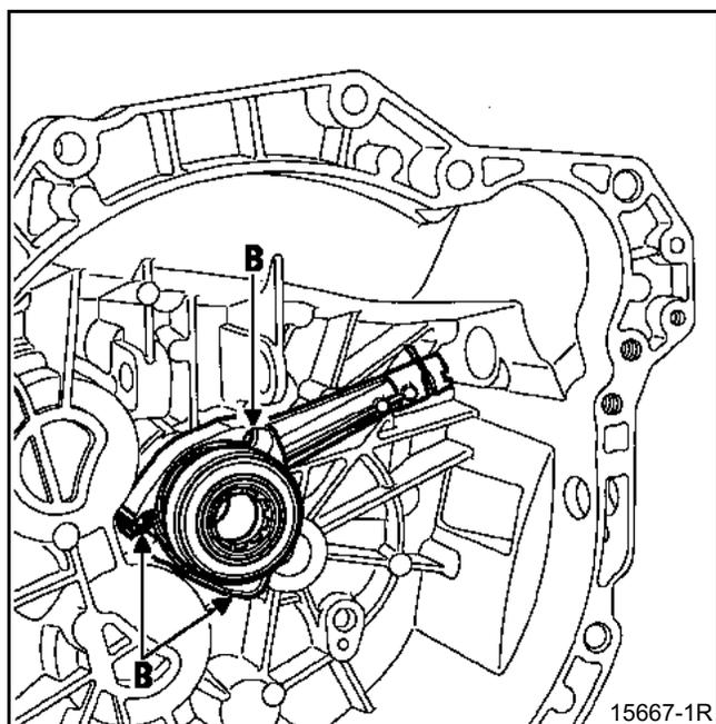
**ВАЖНОЕ ЗАМЕЧАНИЕ:** чтобы не повредить рабочий цилиндр, не наносите смазку на первичный вал коробки передач.
