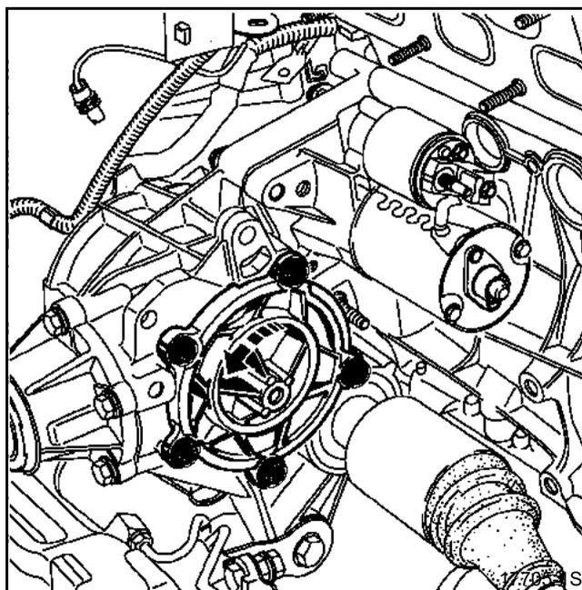
Снимите крышку картера дифференциала, повернув ее по направлению стрелки.
