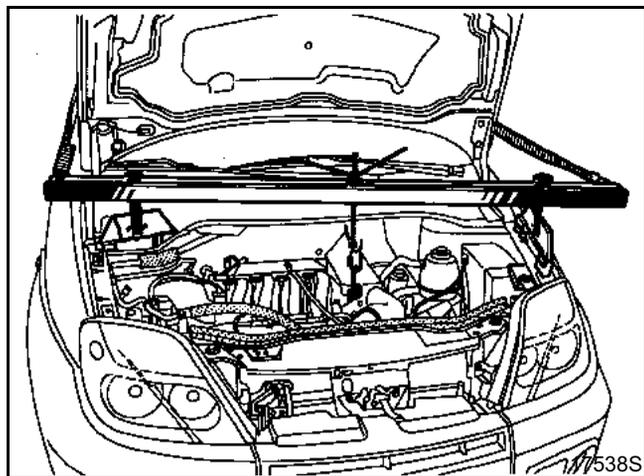
На левой стороне автомобиля вставьте защитную прокладку между крылом и грязезащитным кожухом крыла, чтобы заполнить пустоту под опорой перекладки для вывешивания двигателя **Mot. 1453**.
