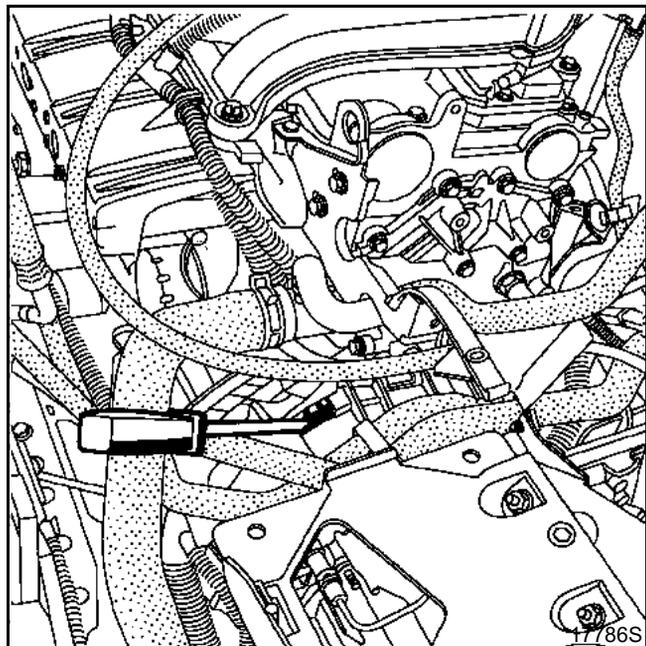
Заблокируйте коленчатый вал, предварительно совместив сделанные ранее метки между зубчатыми шкивами распределительных валов и крышкой подшипников распределительных валов. Эти метки должны быть совмещены, т.к. это позволяет удостовериться, что фиксатор находится в предназначенном для него отверстии, а не в балансировочном отверстии коленчатого вала.
