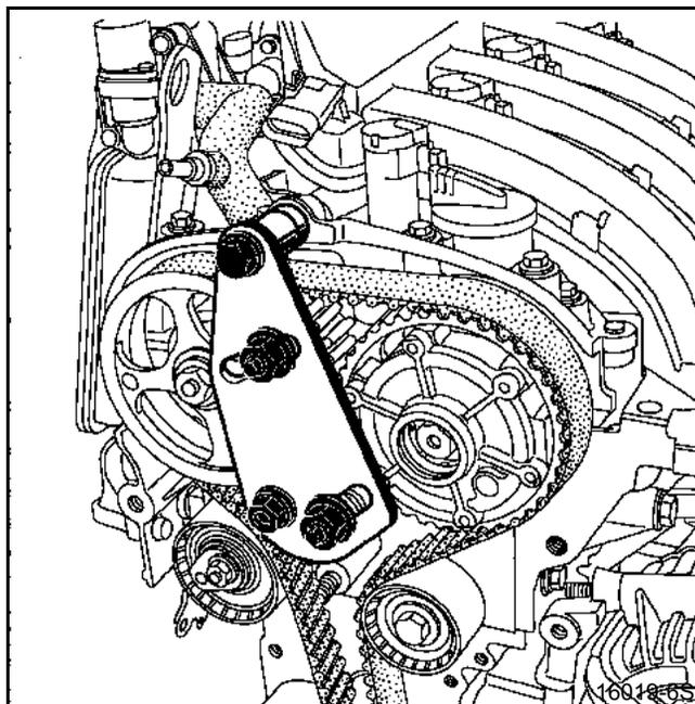
Затяните новый болт крепления фазорегулятора распределительного вала **впускных клапанов** моментом **10 даН.м**.
