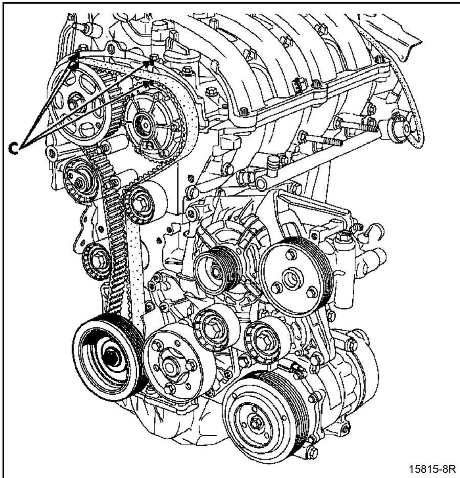
Снимите приспособление **Mot. 1496** для фиксации распределительных валов и фиксатор верхней мертвой точки **Mot. 1054**.
