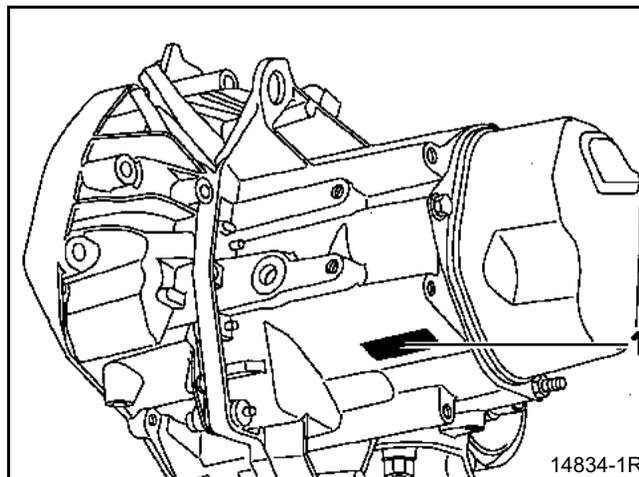
На табличке (1), закрепленной на картере коробки передач, указаны:
