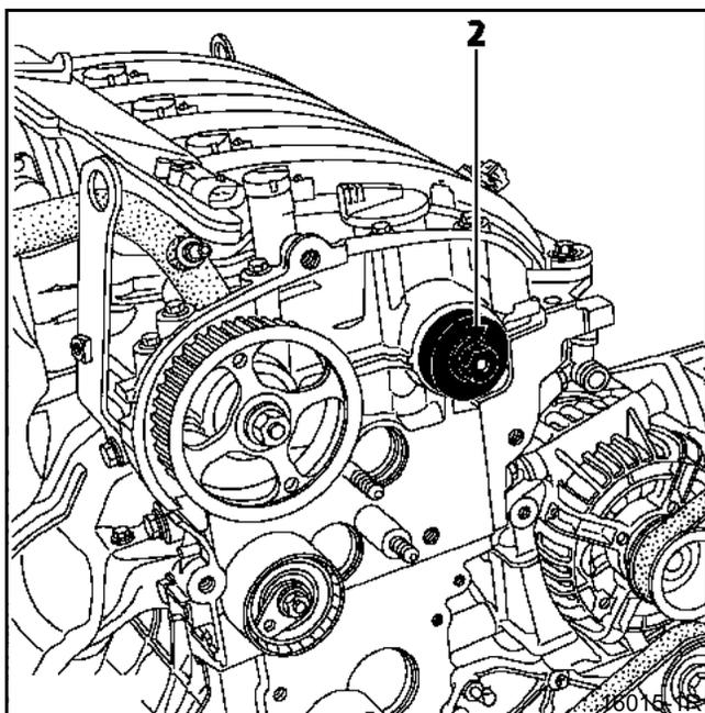
**ПРИМЕЧАНИЕ:** чтобы использовать приспособление **Mot. 1517**, обязательно разверните отверстие под диаметр 13 мм.
