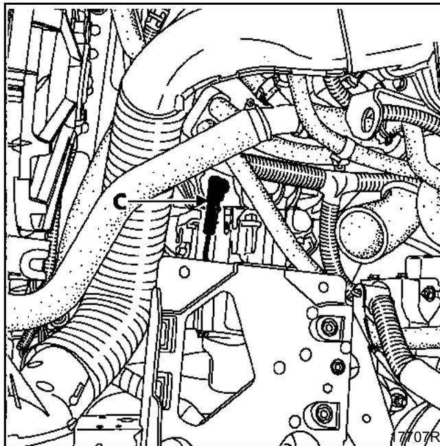
Снимите защиту поддона двигателя.
