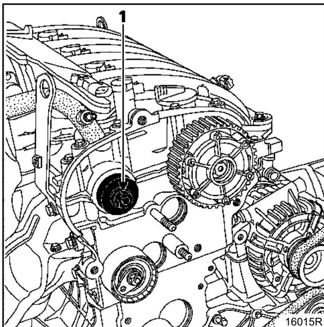
Установите уплотнительную манжету фазорегулятора впускного распределительного вала с помощью приспособления **Mot. 1517** используя прежний болт (2).
