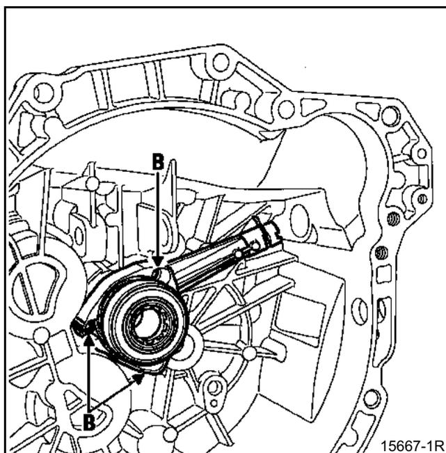
**ВНИМАНИЕ!** ни в коем случае не нажимайте на педаль сцепления при снятом рабочем цилиндре (даже если он остается соединенным с педалью сцепления), чтобы не допустить выталкивания поршня и упора из рабочего цилиндра.
