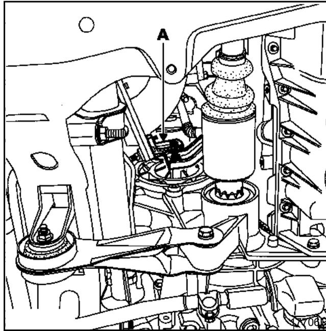
Высвободите коллектор, повернув его примерно на  $45^\circ$ , затем извлеките, подавая в сторону.
