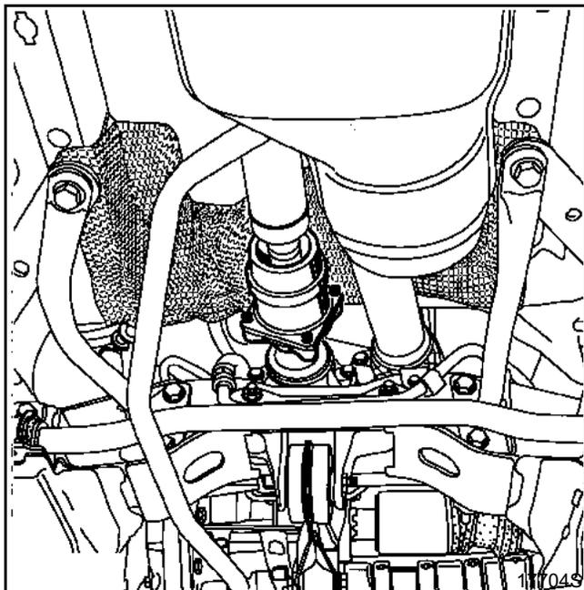
Снимите каталитический нейтрализатора, потянув за него вдоль карданного вала.
