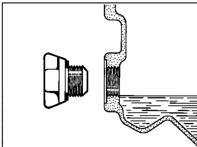
Заполните картер коробки передач маслом до нижней кромки отверстия.
