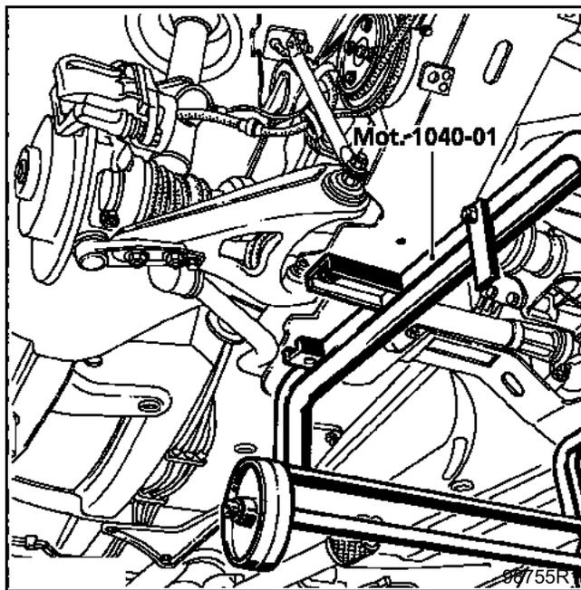
Опустите подрамник до касания приспособления с грунтом.
