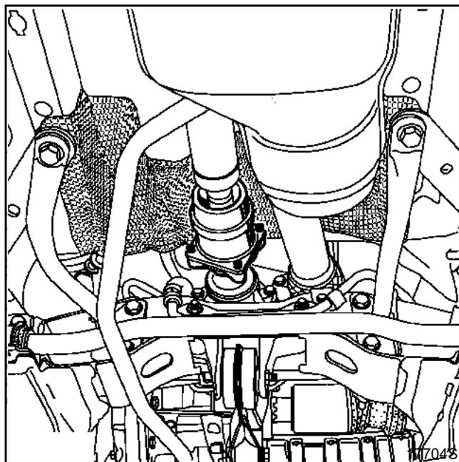
Отсоедините карданный вал от коробки передач.
