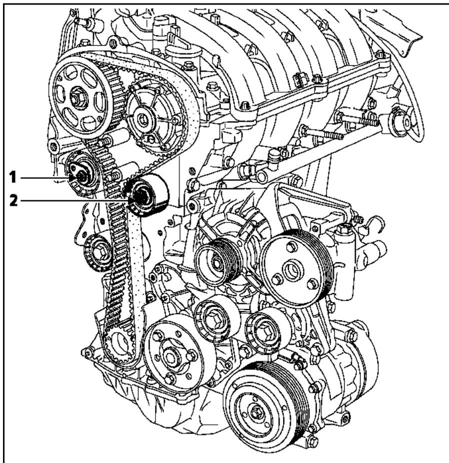
**ВНИМАНИЕ:** обязательно обезжирьте носок коленчатого вала, отверстие зубчатого шкива коленчатого вала и опорные поверхности шкива, чтобы избежать проскальзывания газораспределительного механизма, которое может повлечь за собой выход из строя двигателя.
