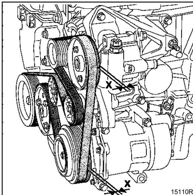
Обязательно проверните на два оборота коленчатый вал, чтобы правильно установить ремень.
