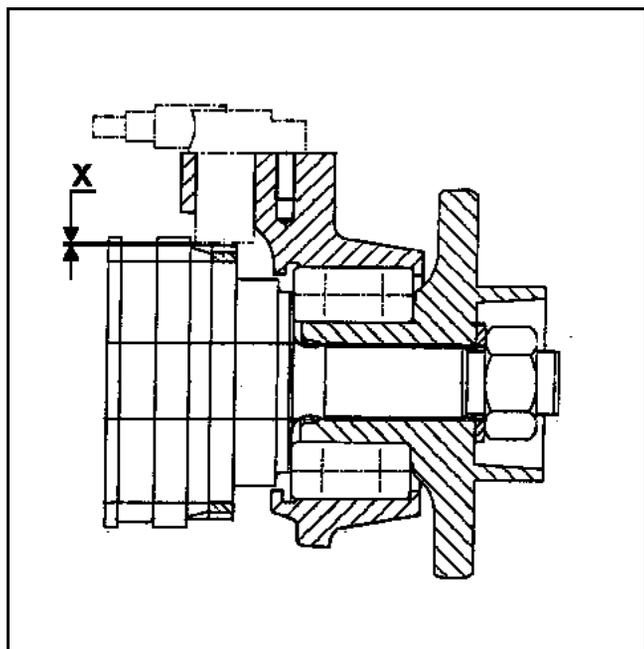
Проверка установочного зазора производится только на автомобилях, оснащенных задними дисковыми тормозами.
