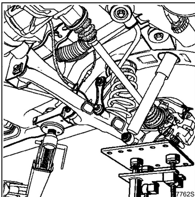
Выверните болт верхнего крепления амортизатора.
