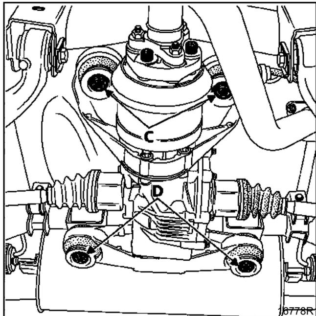
– переднюю опору, удалив пять болтов крепления.
