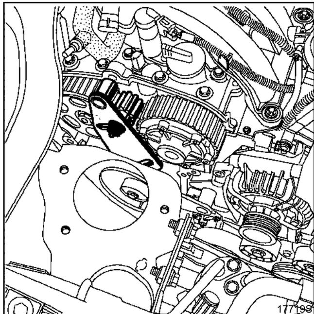
– верхний болт (3), поместив распорную втулку (4) приспособления **Mot. 1509-01** между приспособлением и крышкой подшипников распределительных валов (**не затягивайте окончательно болт**).
