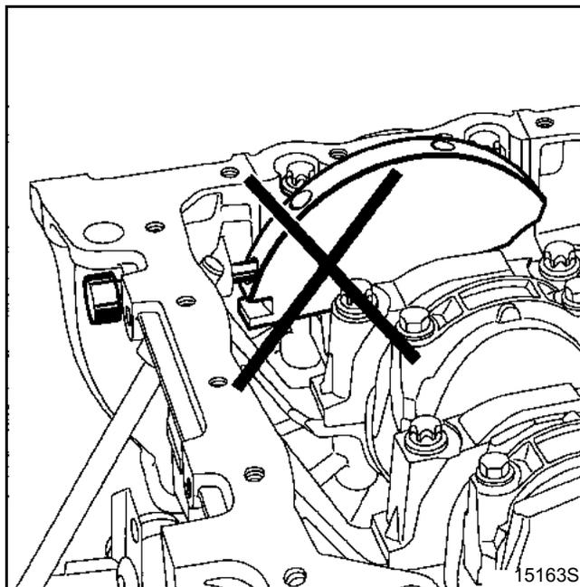
Установите приспособление для фиксации зубчатых шкивов распределительных валов **Mot. 1509**, оснащенное дополнительным элементом приспособления **Mot. 1509-01**.
