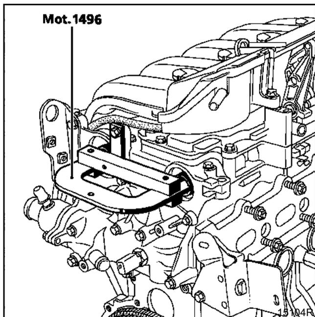
Снимите старую гайку крепления зубчатого шкива, старый болт крепления фазорегулятора и замените их новыми (зазор между гайкой или болтом и шкивами распределительных валов должен составлять 0,5 - 1 мм).
