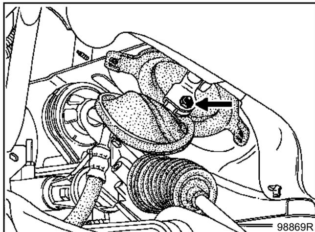
Установите зажимы на трубопроводы, отходящие от бачка насоса гидроусилителя рулевого управления.
